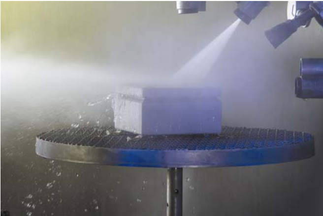
Foto: IP Schutzartprüfung, Quelle: Fraunhofer ICT
